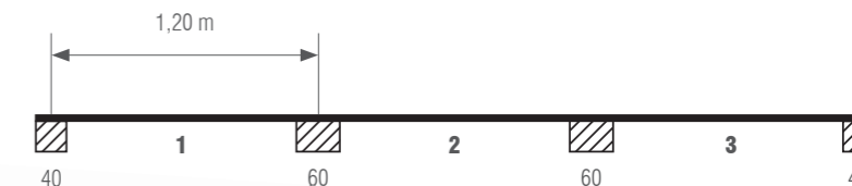
Belastungswerte nach Eurocode 3 (EN 1993-1-3): Profil in Negativlage, Dreifeldträger, Endauflagerbreite 40 mm, Zwischenauflagerbreite 60 mm
