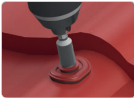
3. Anziehen bis Dichtung leicht komprimiert
